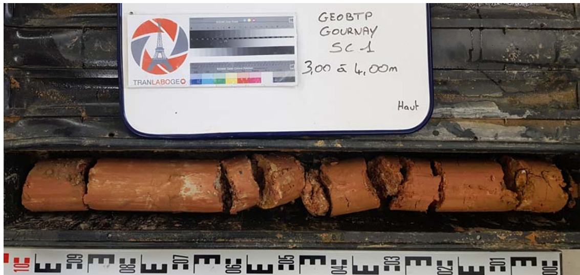
Argile plastique orange, passage d'argile grisâtre et pisolithe rouille
